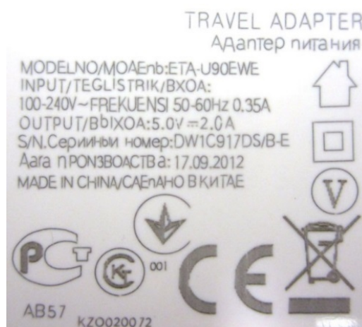
Figur 25: Märkning av laddaren från Lidu, ETA-U90EWE
