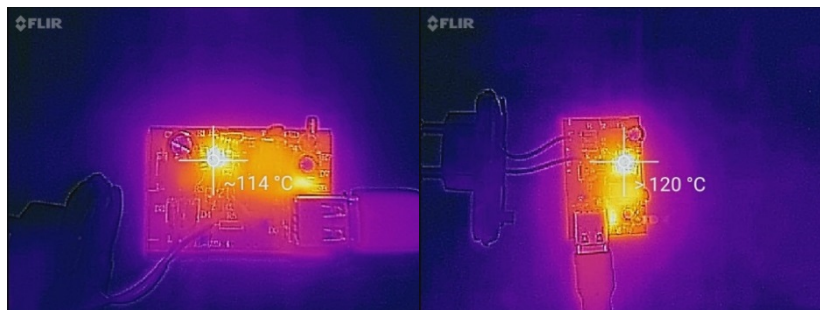
Figur 41: Omärkt laddare, A08-06, temperaturmätning
