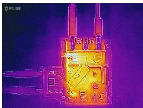
Figur 47: IKEA Koppla, 002.918.91, temperaturmätning
