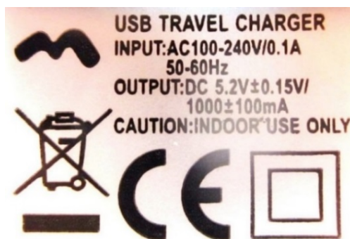
Figur 36: Märkning av utspänning och ström på en USB-laddare
